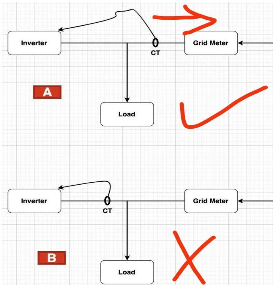
1. La posizione di installazione del sensore CT nella figura A è corretta, la posizione di installazione del sensore CT nella figura B è errata. Non importa se non si dispone di un contatore installato, è necessario osservare la relazione posizionale tra l'inverter, il carico e il sensore CT nel sito di installazione. Quindi confronta con la relazione di posizione dei tre nella foto.
